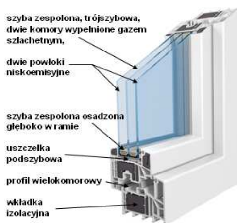
Rys. 1. Przekrój okna pasywnego
