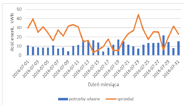
Rys. 7. Wielkość produkcji energii elektrycznej, przeznaczona na potrzeby własne właściciela instalacji oraz sprzedawanej do sieci elektroenergetycznej w sierpniu 2016 r.
