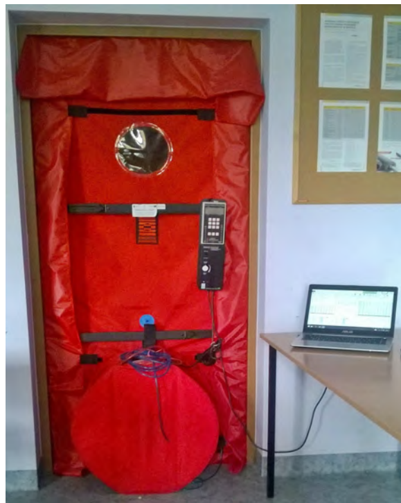
Rys. 1. Urządzenie testujące Blower Door (fot. autorki)
