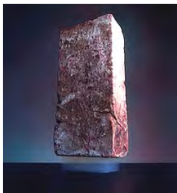
Rys. 2. Cegła ustawiona na aerożelu [3]
