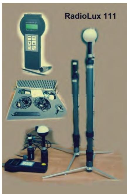
Fig. 1. Photometer RadioLux 111
