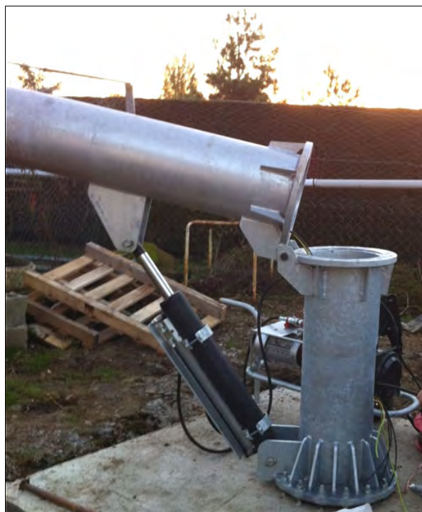
Rys. 3. Osprzęt do łamania masztu rurowego wg [3]
