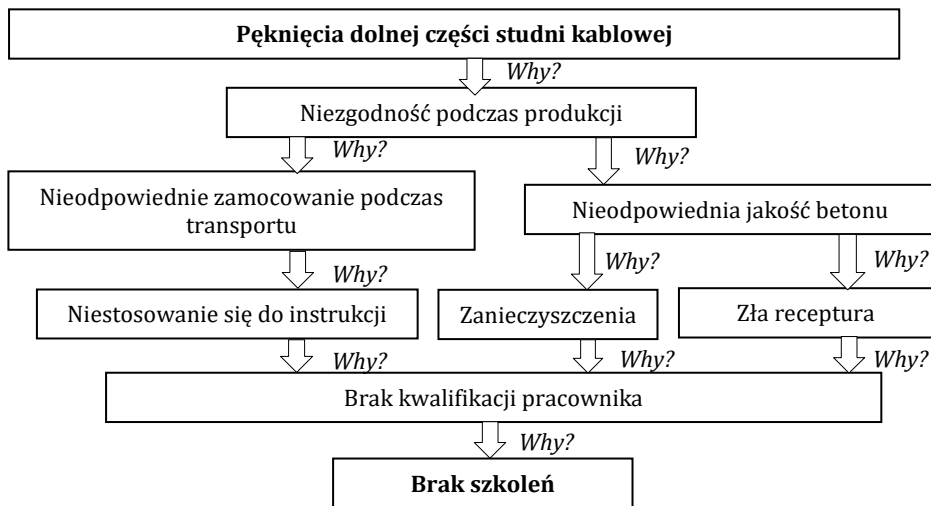
Rys. 3. Metoda 5Why dla problemu pęknięć dolnej części studni kablowej
